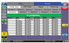
簡単なサマリーの合格/不合格結果テーブルとドリルダウン機能 が、各サービスの詳細な測定結果(フレーム損失、フレーム伝送 遅延、フレーム遅延変動、可用性)を表示
