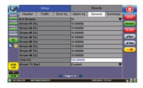
1GEインタフェースの設定可能なフィルタを使用して、最大10個の個別のトラフィックストリームを生成および解析
