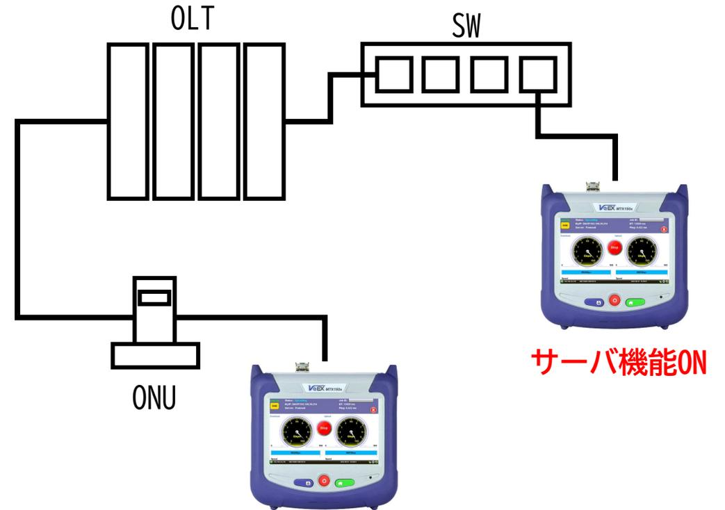
Ookla Speed Testサーバへの網外試験の他、測定器を2台用意し、iPerf3アプリケーションを使った網内試験も可能です
