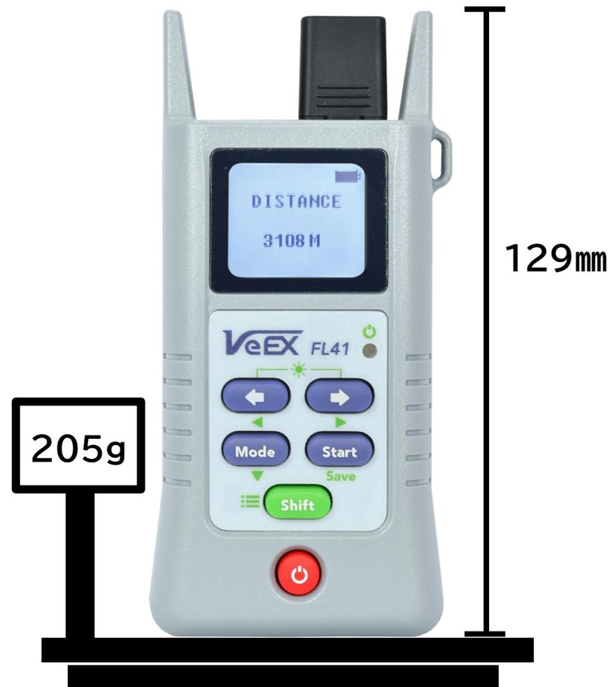
手のひらサイズで低価格の光ケーブル故障診断ツールです
