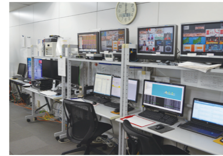
東京・赤坂にあるネットセーブ本社内のネットワークオペレーションセンター(NOC)。ここで全国各地のケーブルテレビ局の伝送路等を、ネットセーブの技術陣がシフト制で24時間遠隔監視している
